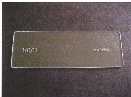
Figura 3 – Lâmina micrométrica de precisão de 1mm, com 100 divisões Fonte: Garcia-Zapata; Souza Jr. - IPTSP, 2010
