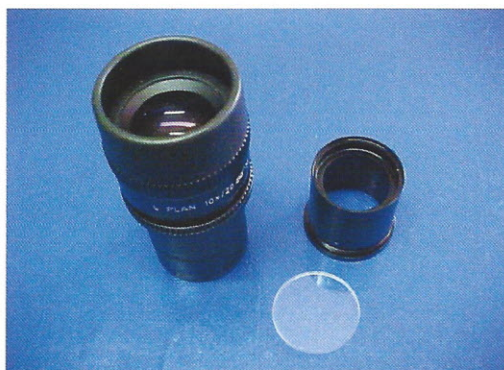
Figura 1 – Ocular do microscópio, mostrando o conjunto (escala e lente) Fonte: García-Zapata; Souza Jr. - IPTSP, 2010
