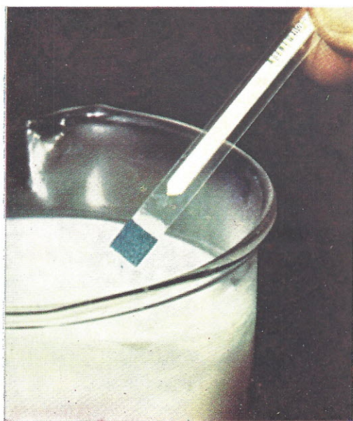
Fig. 2 — Tira "Clinistix" mostrando área reagente azul, índice específico positivo para a presença do peróxido de hidrogênio na amostra de leite examinada.
